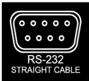
RS-232連接允許連接到相容的控制系統。控制系統應配置為使用115200/8-N-1，無流量控制協定。電纜連線方式應為一對一。
